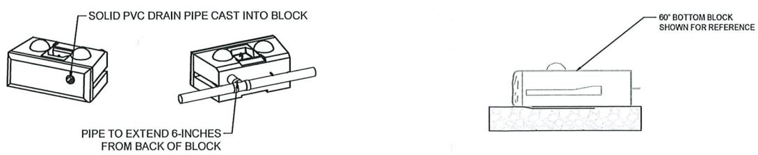
DRAIN BLOCK TYPICAL DETAIL
