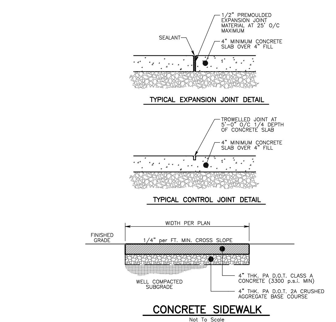
TYPICAL CONTROL JOINT DETAIL
